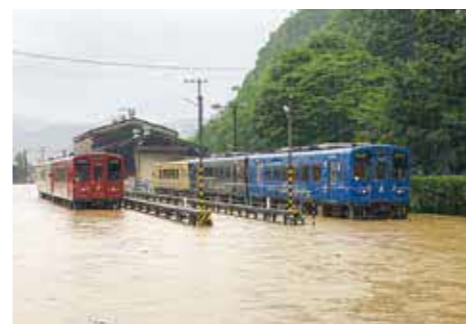
▲豪雨災害で浸水被害を受けた車両
